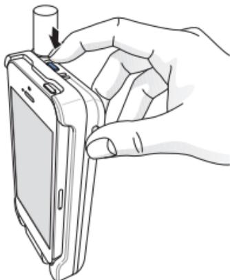
Halten Sie zum Ausschalten des SatSleeve die Ein/Aus-Taste etwa 2 Sekunden lang gedrückt, bis alle roten LEDs kurz aufleuchten und ein Signalton zu hören ist.
